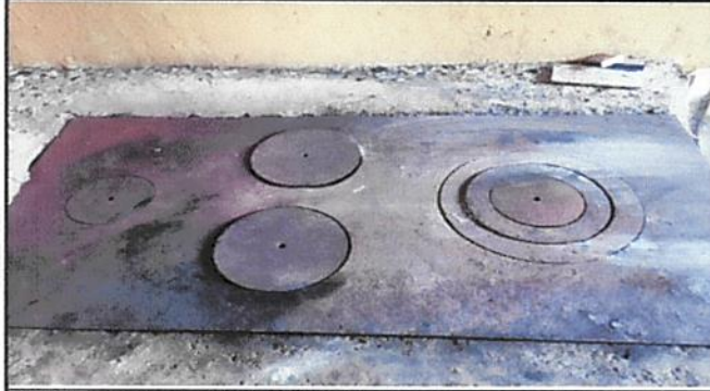
Foto 7: Plancha de estufa en mal estado
